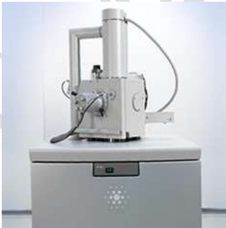
Рисунок 2.9 – Скануючий електронний мікроскоп SEO-SEM Inspect S50-B (СумДУ)
