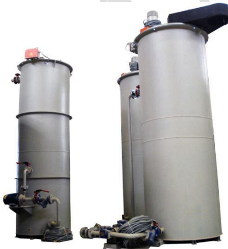
Рисунок 5.9 – Охолоджувальні ванни типу ВШМ фірми «Накал»
