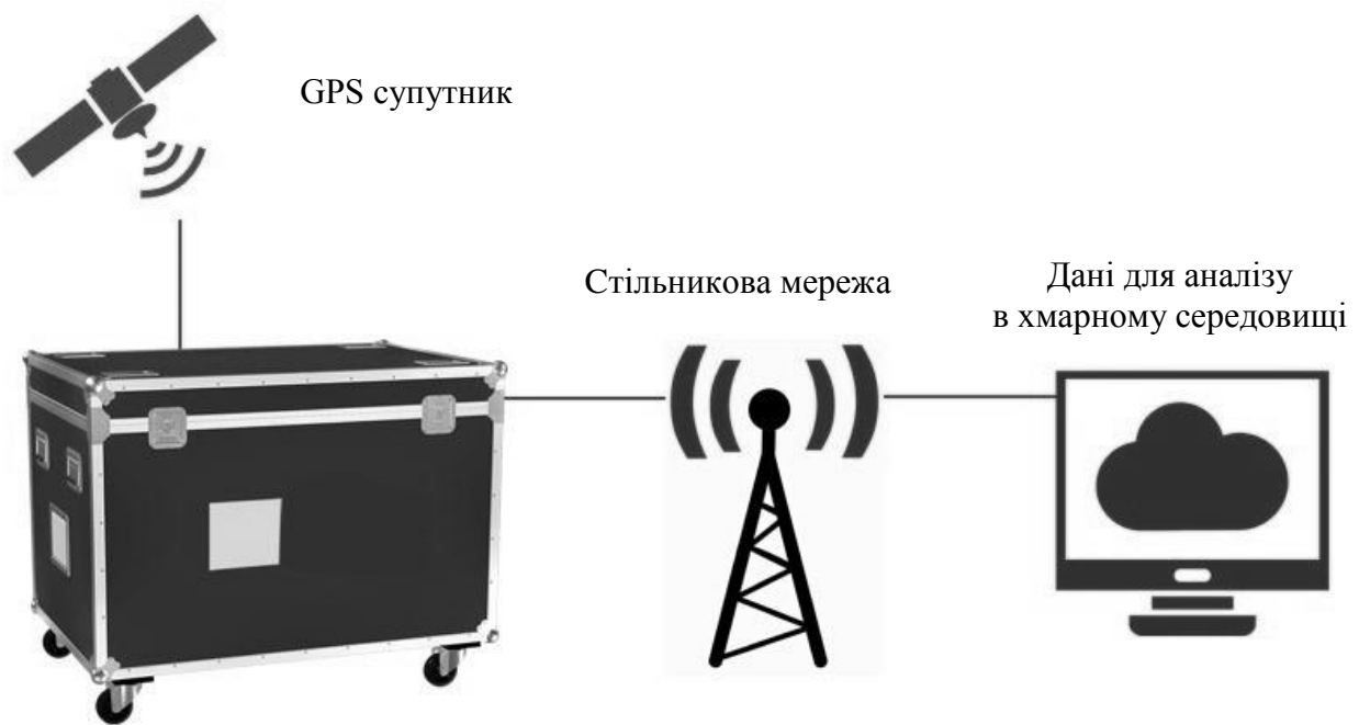
Рисунок 3.9 - Скриньки, в яких повинні транспортуватися товари при використанні технологій «IoT» (Промисловий Інтернет речей та сенсорних мереж, 2020)
