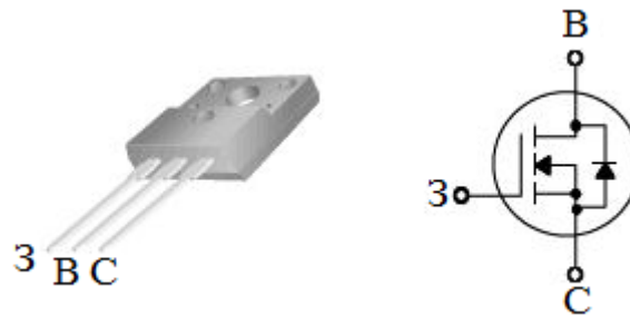
Рисунок 2.4 – Зовнішній вигляд та схематичне зображення транзистора FQPF2N60C. Адаптовано із роботи [10]
