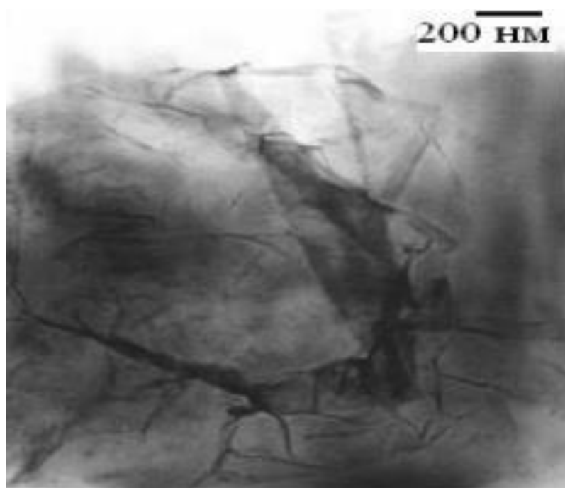
Рисунок 2.5 – ТЕМ колоїдної частинки оксиду графіту [6]
