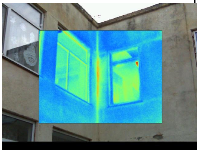
Підвищена температура зовнішньої поверхні стіни (особливо у кутовому з'єднанні стін) свідчить про втрату стінами теплозахисних властивостей.
