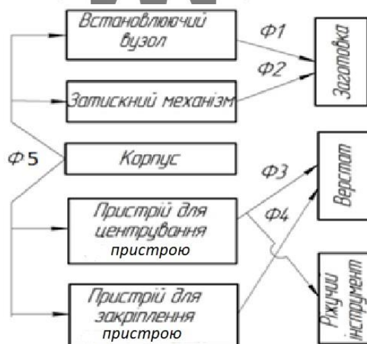
Рисунок 18 – Функціональна структура проектованого пристрою [7]
