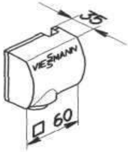
Рисунок 2.10 - Накладний датчик температури
