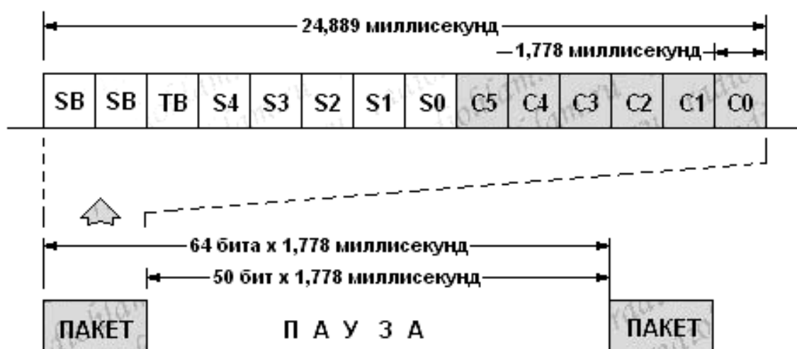
Рисунок 2.2– Формат передачі даних по протоколу RC-5
