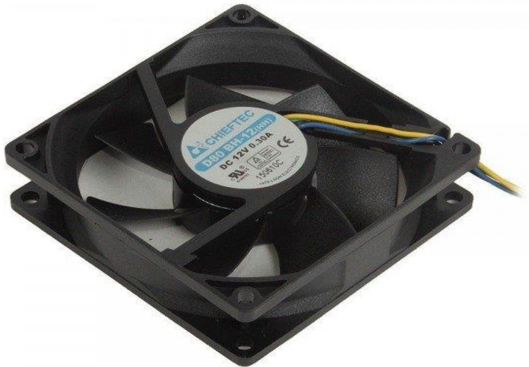
Рисунок3.4. – Корпусний вентилятор, 80 мм, 2700 об/мін
