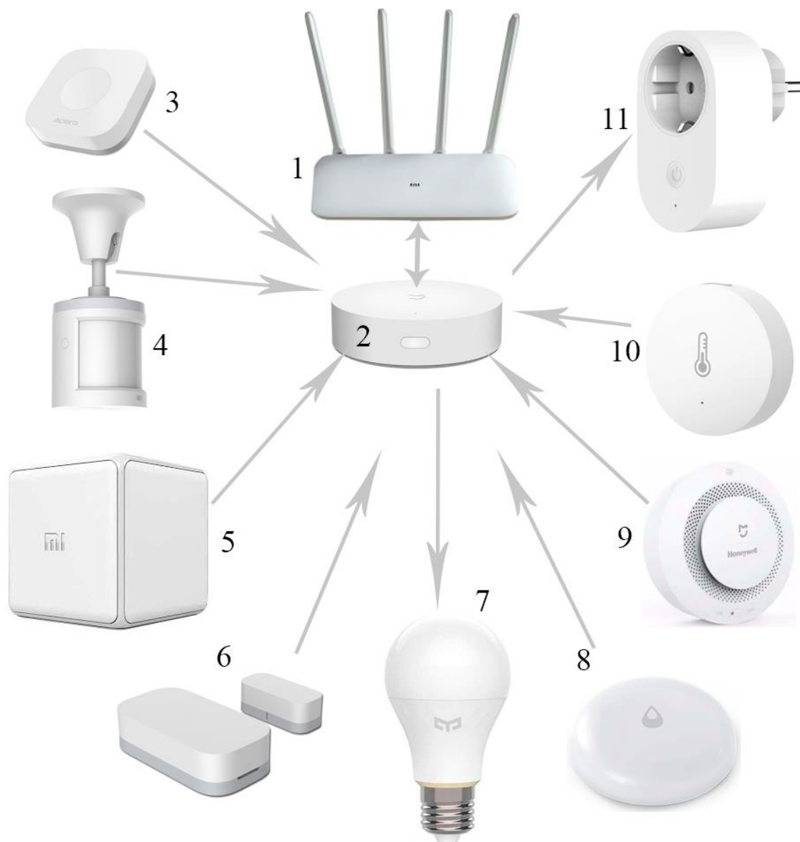
Рис. 2.4 – Архітектура системи розумний будинок, побудована на основі пристроїв Xiaomi з підтримкою протоколу ZigBee: 1 – Wi-Fi маршрутизатор; 2 – ZigBee шлюз Mi/Miija V3; 3 – бездротова кнопка; 4 – датчик руху; 5 – куб-контролер; 6 – датчик відкриття; 7 – розумна лампочка; 8 – датчик протікання рідини; 9 – датчик газу (диму); 10 – датчик температури та вологості; 11 – розумна розетка
