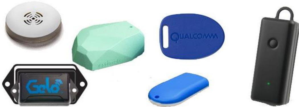
Рис 1.6 – Маячки Bluetooth, реалізовані у вигляді окремих пристроїв. Адаптовано з роботи [9]
