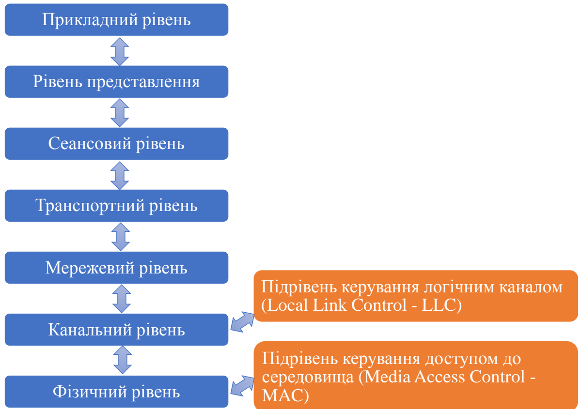
Рис 1.2 – Протокол Wi-Fi в моделі OSI. Адаптовано з роботи [4]
