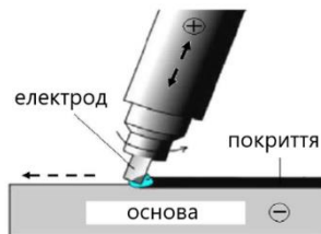
Рисунок 1 – Схема формування покриття методом ЕІЛ
