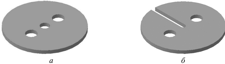
Рисунок 1 – Ескіз «шайби-прихвата»: a ) виконання A , б ) виконання B
