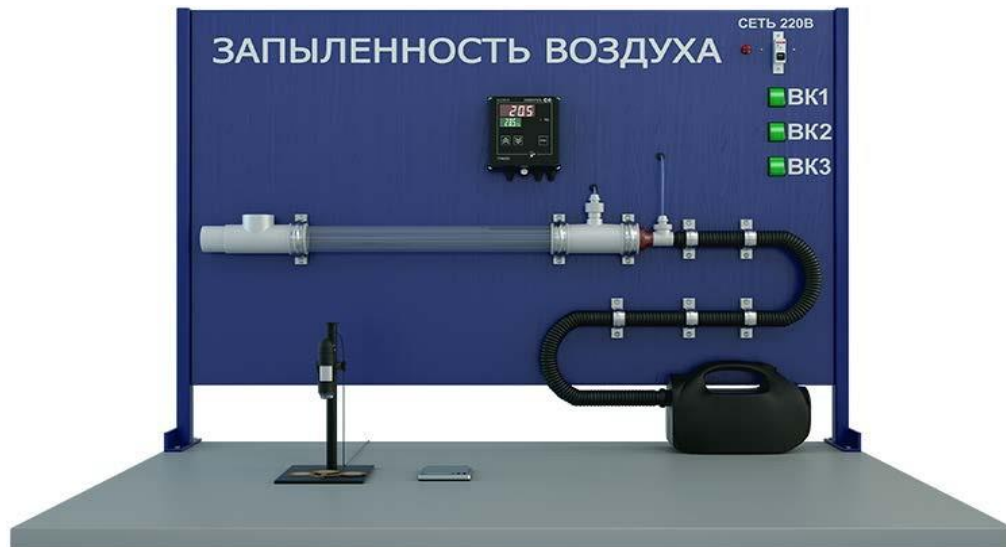
Рисунок 2.1 – Лабораторний стенд запиленості повітря
