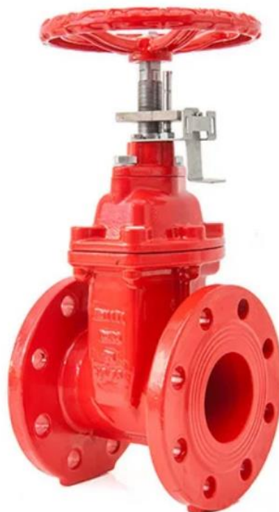
Рисунок 3.9 - Клинова засувка мод.117FF NRS, DN50 PN16
