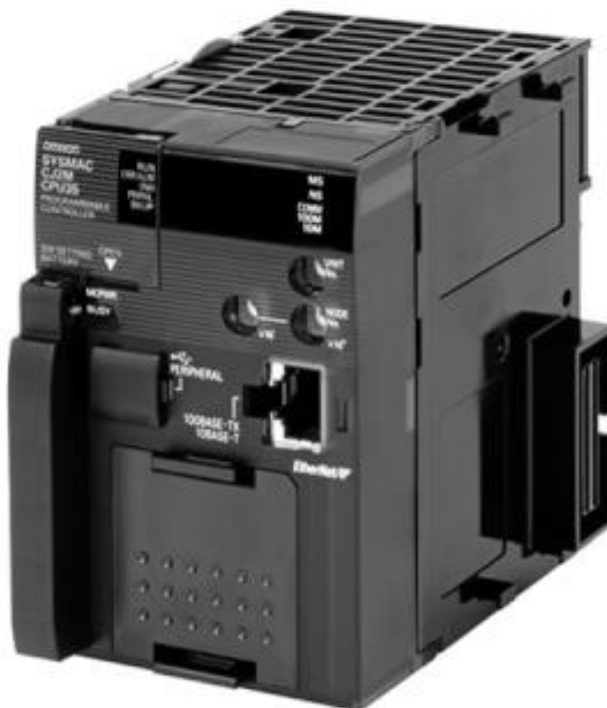
Рисунок 23. Зовнішній вигляд ПЛК OMRON CJ2M – CPU31
