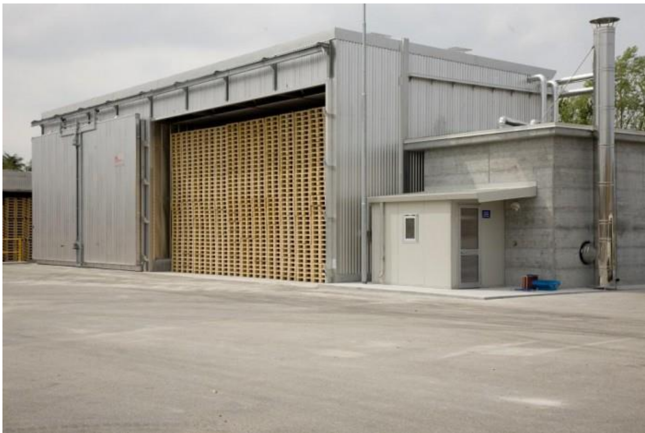
Рисунок 1.1 – Загальний вигляд сушильного агрегату деревини камерного типу
