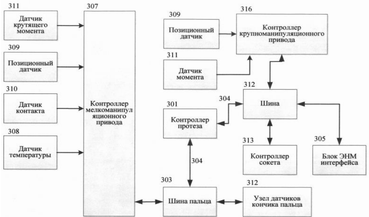
Рисунок 1.2 – Блок-схема системы керування інтелектуальною біонічною кінцівкою руки
