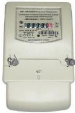
Рисунок 1.5 – Лічильник електричної енергії Меридиан СО Э-1.02/2 [6]
