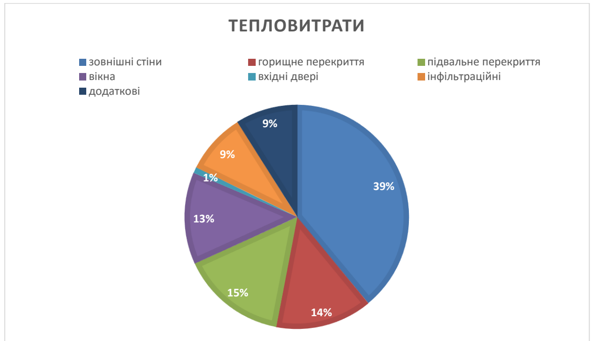
Рисунок.2.4 Тепловтрати через огорожуючі конструкції
