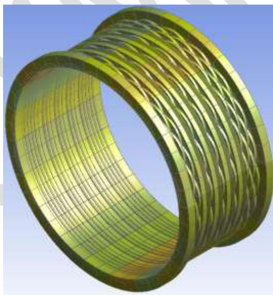
Рисунок 2.7 – Геометрія та граничні умови потоку лабіринтно-лункового ущільнення
