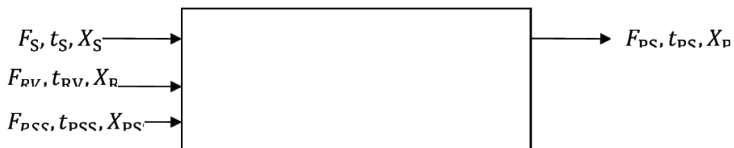
Рис.2.1 – Параметрична схема апарату попередньої очистки дифузійного соку
