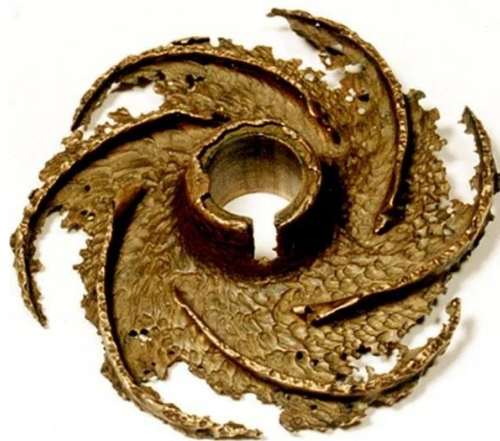
Рисунок 18 – дія кавітації на метал
