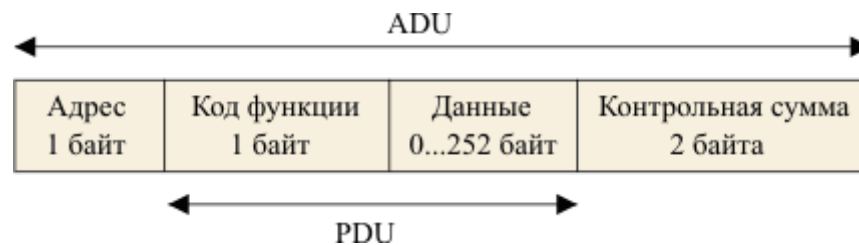
Рисунок 1.12 - Формат кадру протоколу Modbus RTU; PDU - "Protocol Data Unit" - "елемент даних протоколу"; ADU - "Application Data Unit" - "елемент даних програми"
