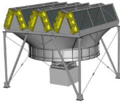
Рисунок 1.5 – Конструкція апарату повітряного охолодження АПЗ
