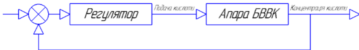
Рисунок 2.4 – Структурна схема управління концентрацією кислоти після апарату БВВК зони 1, 2, 3, 4
