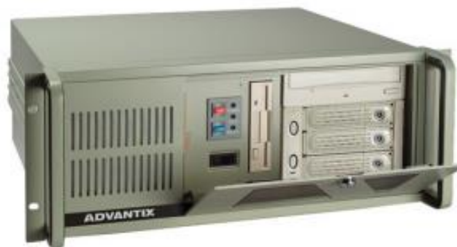
Рисунок 3.28 – Станція оператора АСУ AdvantiX IPC-SYS1-3-A9
