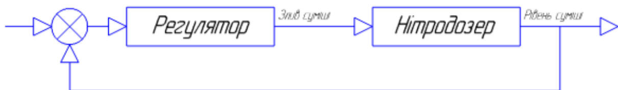
Рисунок 2.3 – Структурна схема управління рівнем в нітродозерах №1, 2, 3, 4 на третьому етапі
