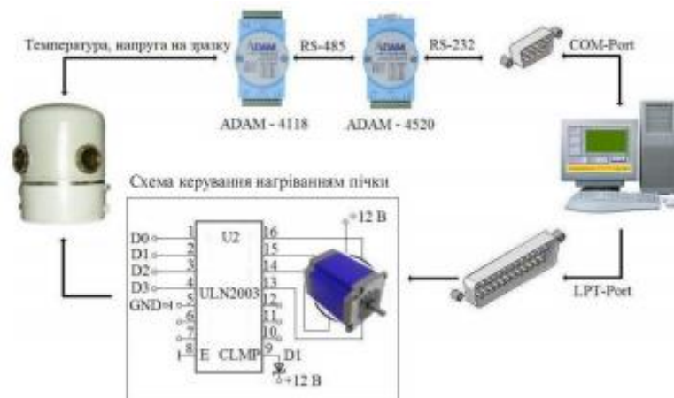
Рис. 2.2. Схема апаратної частини автоматизованого комплексу для дослідження терморезистивних властивостей. Адаптовано із роботи [76]
