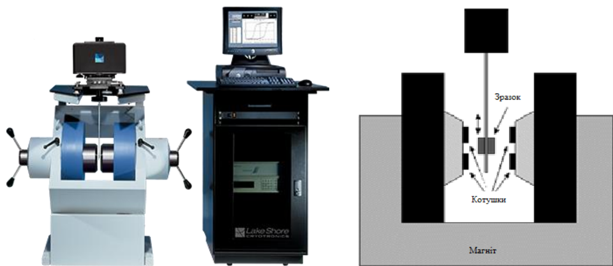
Рис. 2.4. Зовнішній вигляд вібраційного магнітометра Lake Shore (а), вимірювальних котушок (б)
