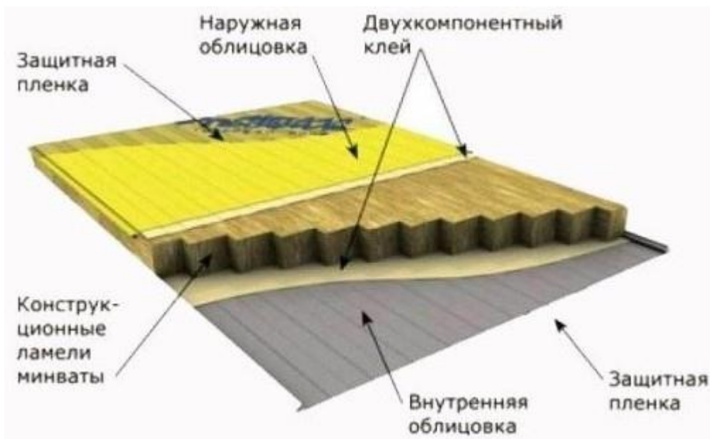
Рисунок 1.1 – Структура сендвіч-панелі на основі базальтового волокна
