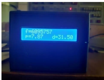
Рис.2.4. – Зовнішній вигляд пристрою для контролю товщини під час процесу конденсації
