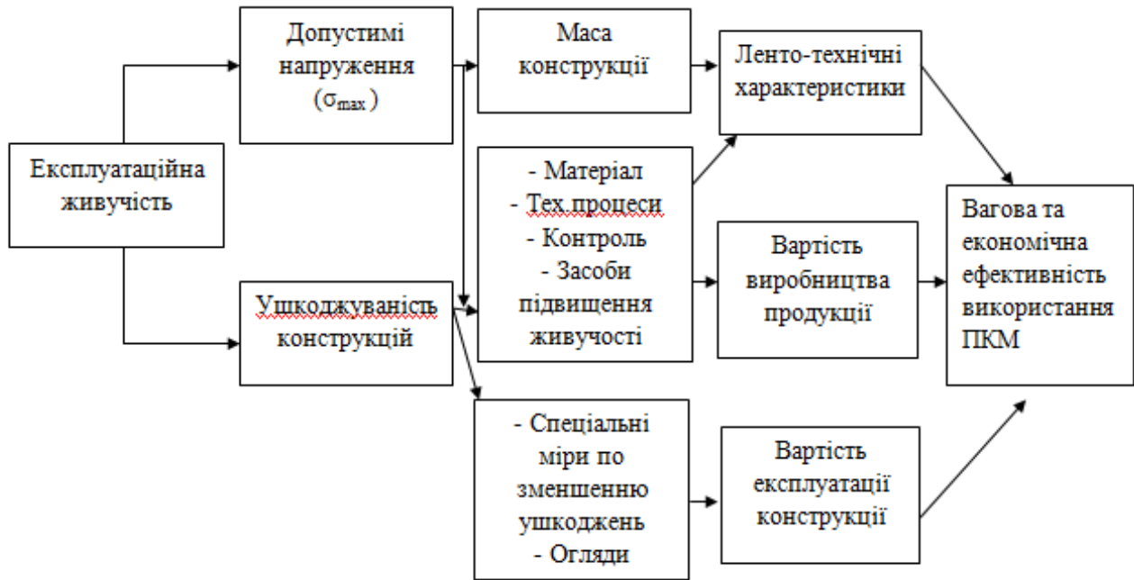
Рисунок 3.11 – Загальна схема підвищення ефективності застосування ПКМ.
