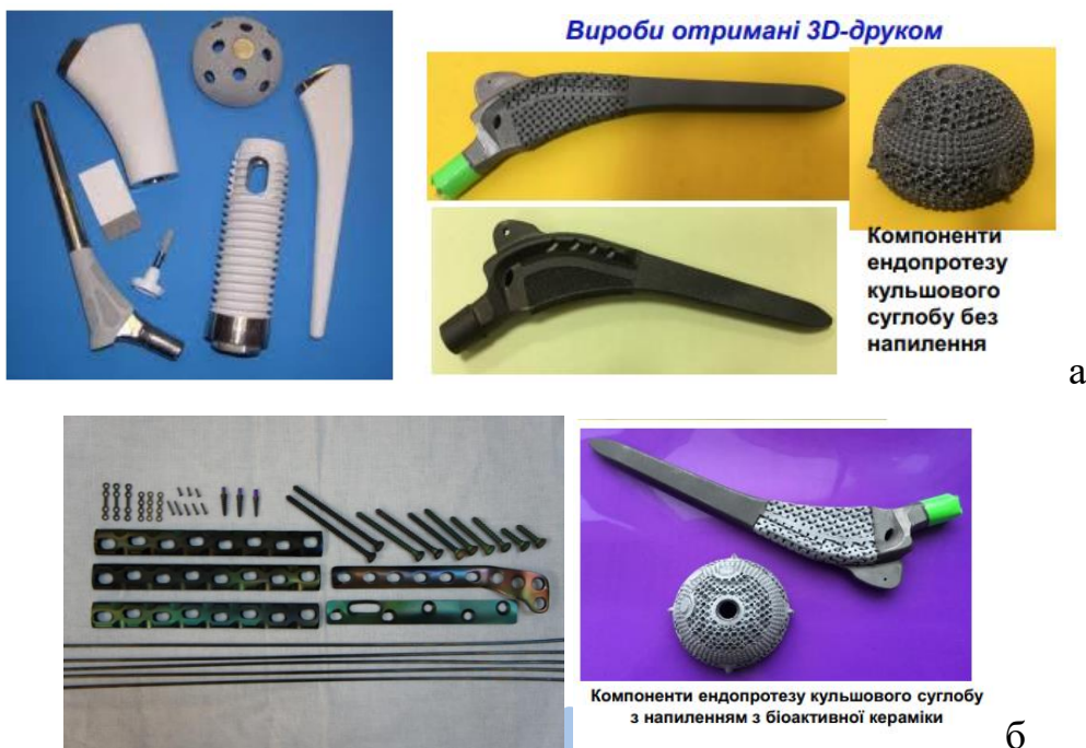
Рисунок 3.1 – Вироби медичного призначення – імплантати (а) і фотографії імплантатів із нанесеними покриттями (б) [80]
