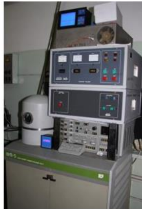
Рисунок 2.5 – Зовнішній вигляд обладнання для наплення КФ покриттів ВУП-5М та джерела живлення системи розпилення [73]
