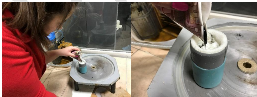
Рисунок 2.6 – Фото процесу заливання 0,1% композиції з додаванням ВНТ ARKEMA в силіконову форму
