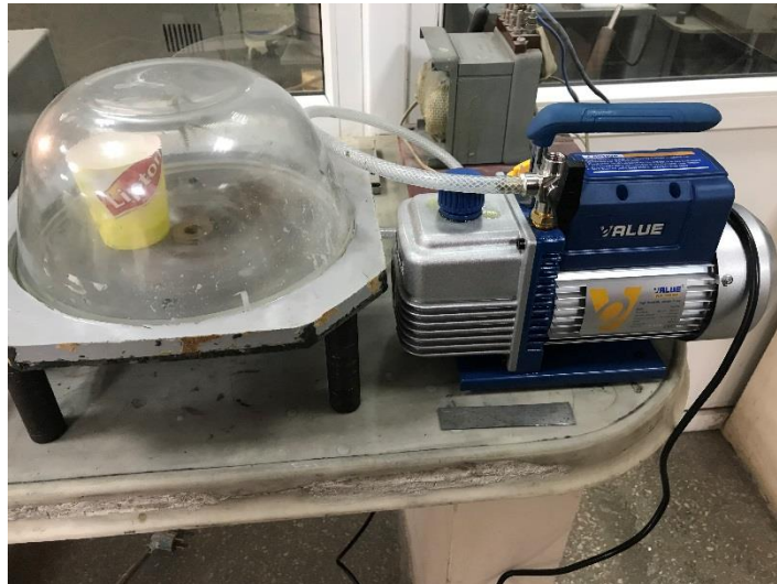
Рисунок 2.4 – Вакуумна шафа та вакуумний насос VE225N: 1 – вакуумна шафа, 2 – насос
