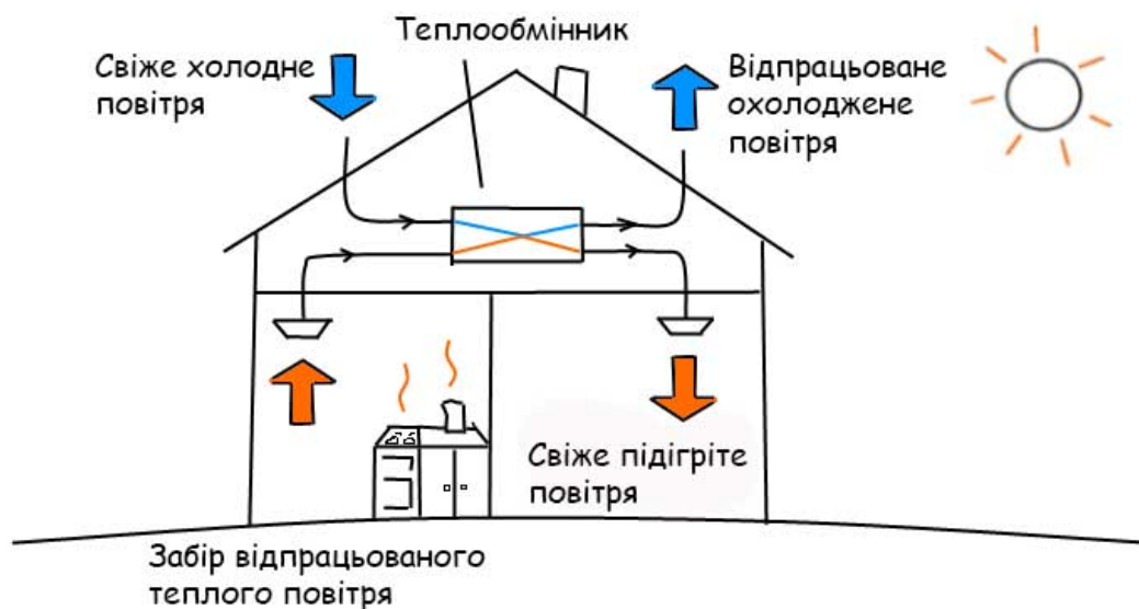
Рисунок 1.4 – Схема роботи механічної системи вентиляції з рекуперацією [11]
