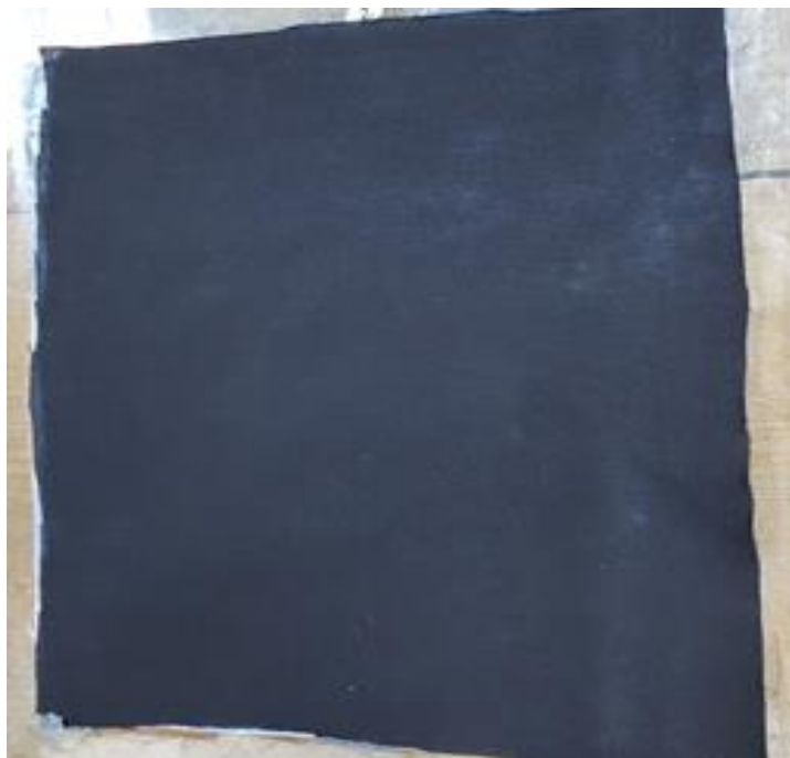
Рисунок 3.5 – Укладання вакуумно-провідного шару.
