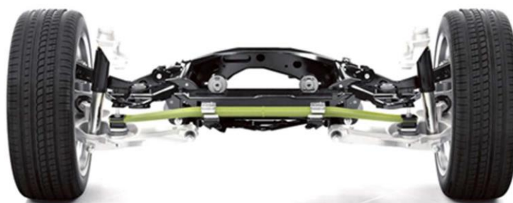
Рисунок 1.2 – Підвіска зі склопластиковою ресорою автомобіля Volvo XC90.
