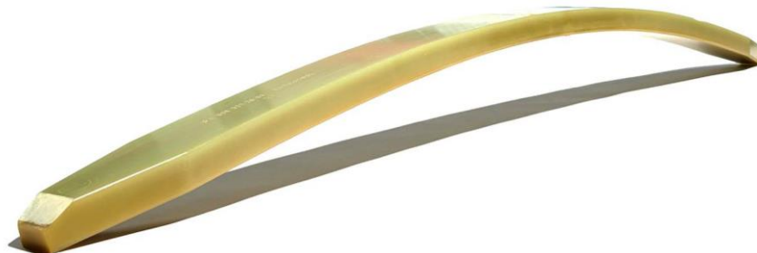
Рисунок 1.3 – Склопластикова ресора автомобіля Volvo 960
