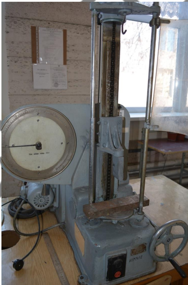
Рисунок 2.1 – Випробувальна машина МПП-100.
