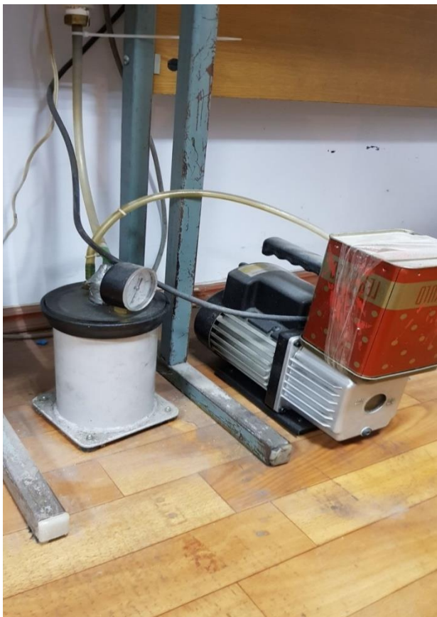
Рисунок 3.7 – Вакуумний насос і ресивер.
