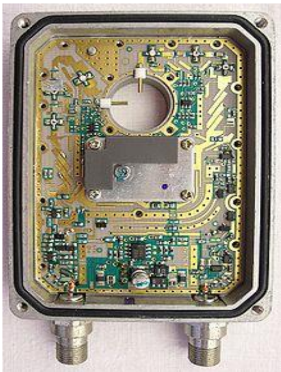
Рисунок - 2.7 - LNB у розібраному вигляді
