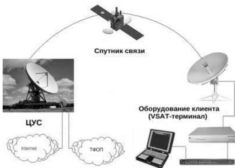
Рисунок 1.2 – Принцип організації супутникового зв'язку VSAT
