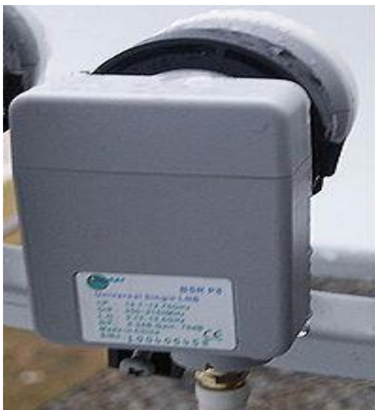
Рисунок 2.5 - Задній вид на LNB з лінійною поляризацією
