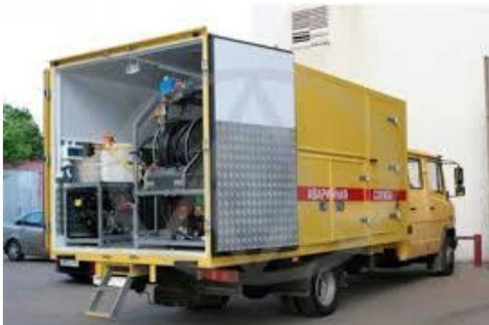
Рисунок 1.8 Автолабораторія з роботизованими системами ремонту
