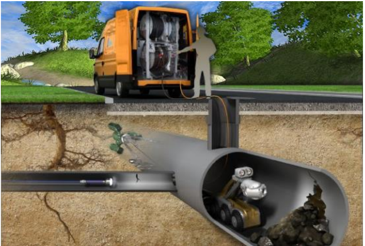
Рисунок 1.2 Метод теледіагностування підземних комунікацій(ССТV),
