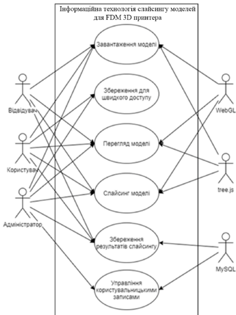
Рисунок 2.6 – Use Case Diagram
