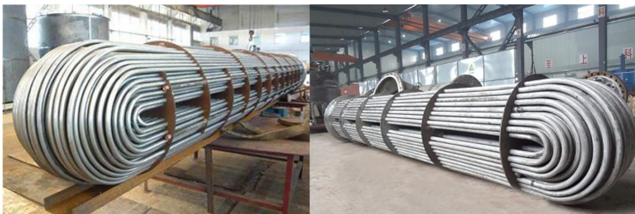
Рисунок 1.4 – Загальний вигляд трубних пучків із U-подібними трубами
