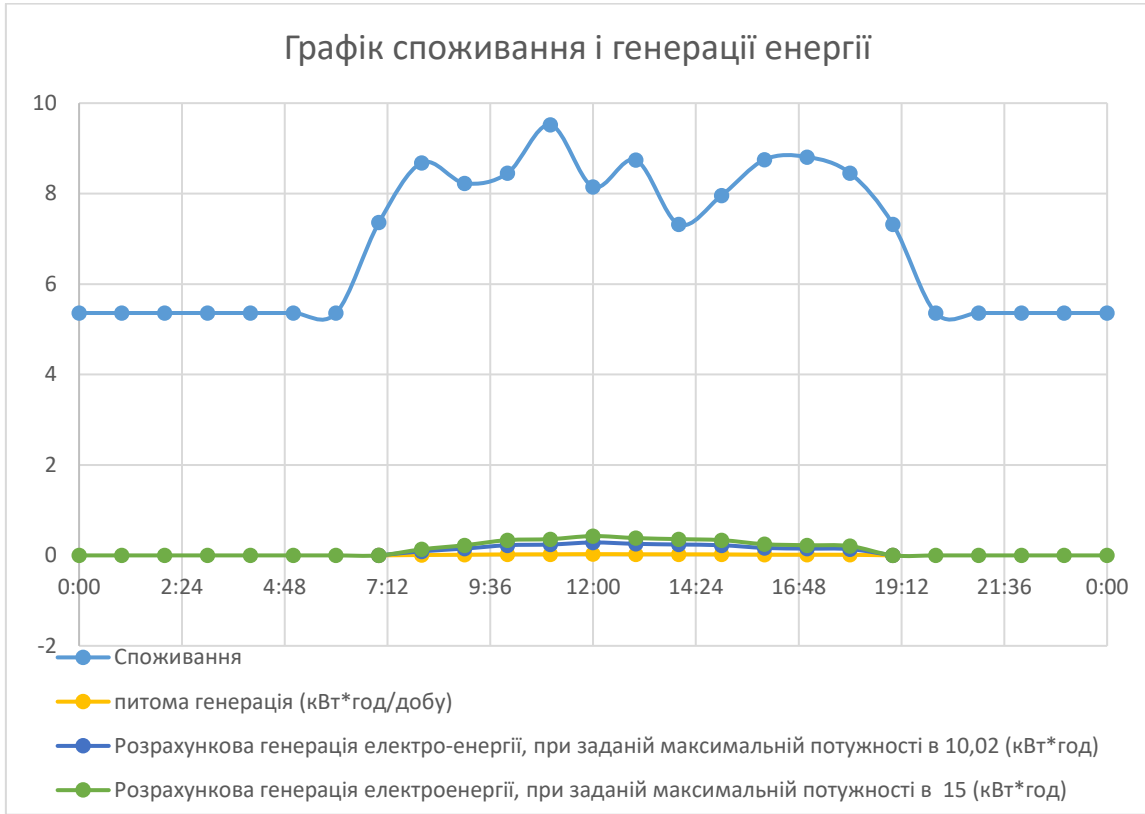
Рис. 2.8 Графіки споживання електроенергії та її питомої генерації на 1кВт встановленої потужності, та генерації електроенергії з встановленою потужністю 10,02 кВт і 15 кВт. За січень місяць.
