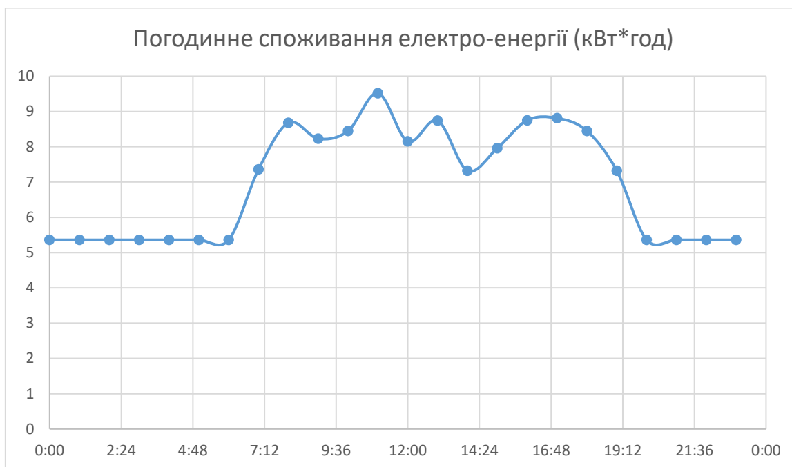
Рис. 2.7 Графік добового погодинного споживання електроенергії струмоприймачами закладу.
