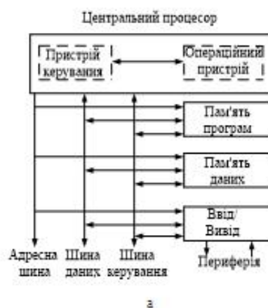
Рис.1.1. Загальна структура мікроконтролера з архітектурою RISC (а) та відлагоджувальна плата для мікроконтролера ATmega8535L (б)
