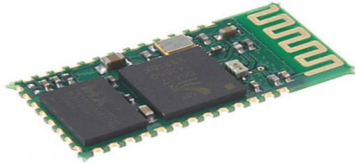
Рис.2.4. Модуль Bluetooth HC-06 [15]
