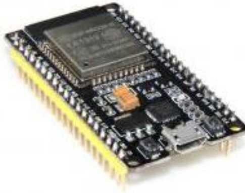
Рис.2.3. Зовнішній вигляд мікроконтролера ESP-32 [14]
