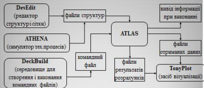
Рис. 2.1. Блок-схема засобів Silvaco TCAD
