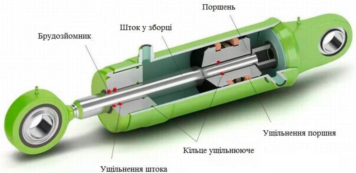
Рисунок 1.4 – Основні елементи поршневого гідроциліндра.
