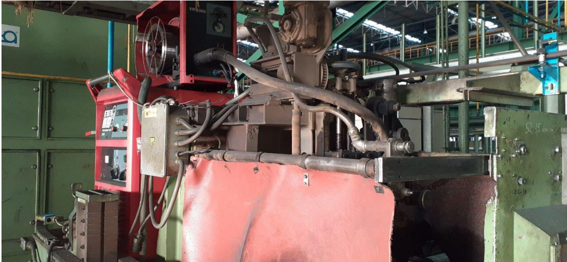
Рисунок 1.4 – Зварювальна установка для відновлення бурильних труб
