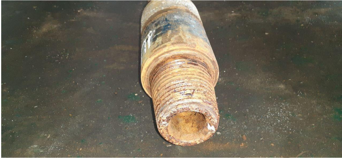
Рисунок 1.2 – Зовнішній вигляд бурильної труби ніпельної частини
