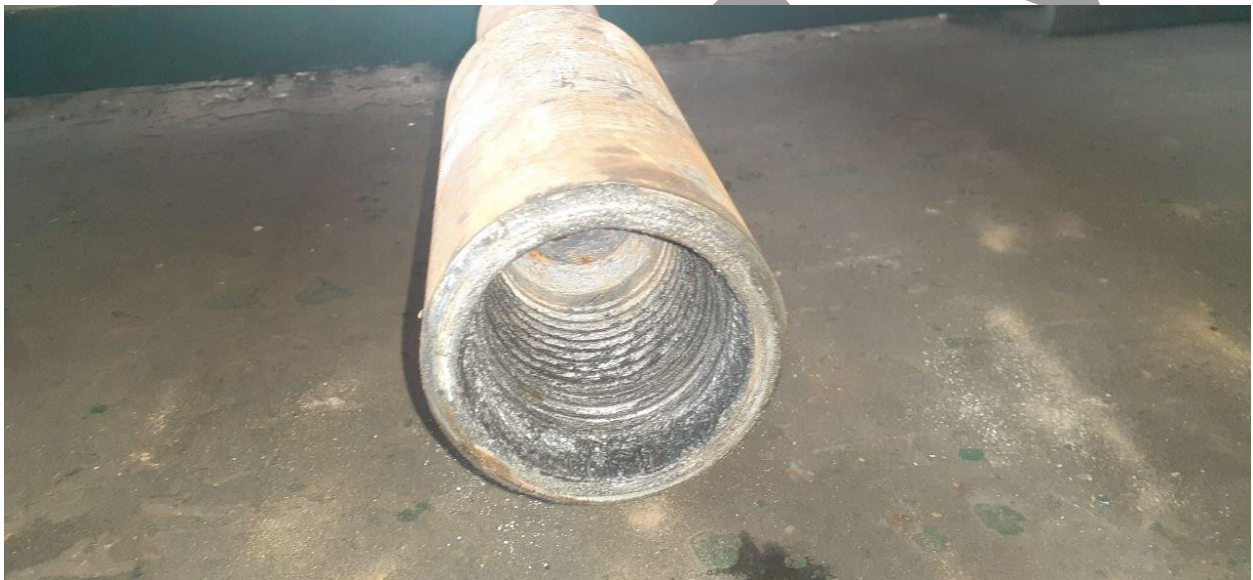
Рисунок 1.3 – Зовнішній вигляд бурильної труби муфтової частини
