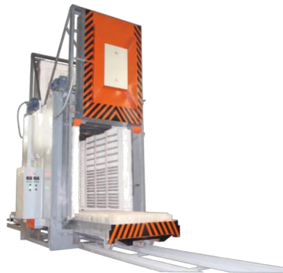
Рисунок 5.3 – Електрична камерна піч типу СДО 8.15.8/12 [31]
