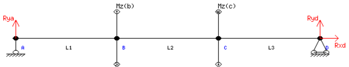
Рисунок 3.20 – Розрахункова схема валу для побудови епюри M_{кр}
