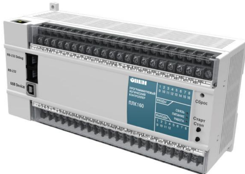
Рисунок 3.21 -Зовнішній вигляд мікроконтролера ОВЕН ПЛК 160.
