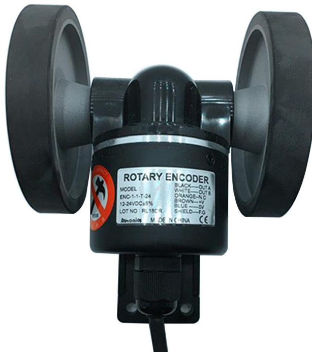
Рисунок 3.15 – Енкодер Autonics ENC.
