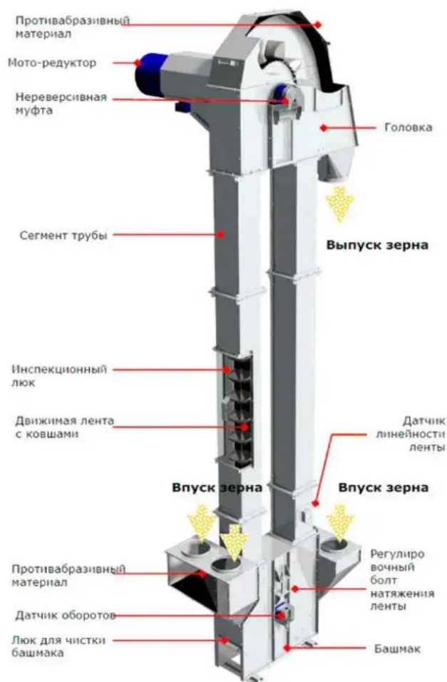
Рисунок 1.4 – Схема норії
