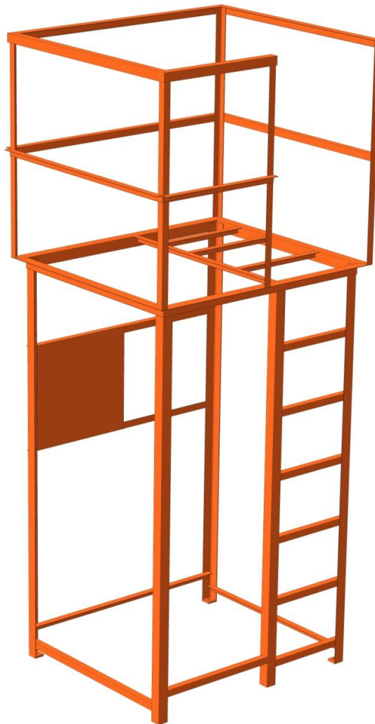
Рис. 19. Рама для монтажу обладнання експериментальної установки
