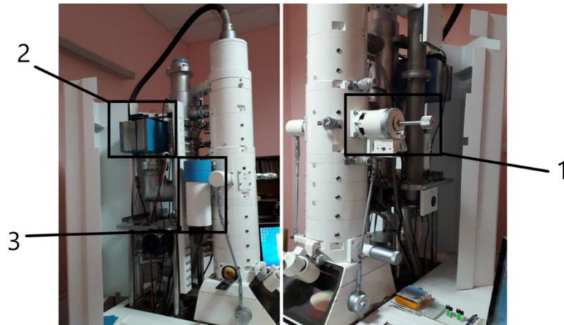
Рисунок 1.6 – Елементи вакуумної системи : 1 – шлюзова камера, 2 – магніторозрядний насос, 3 – дюар
