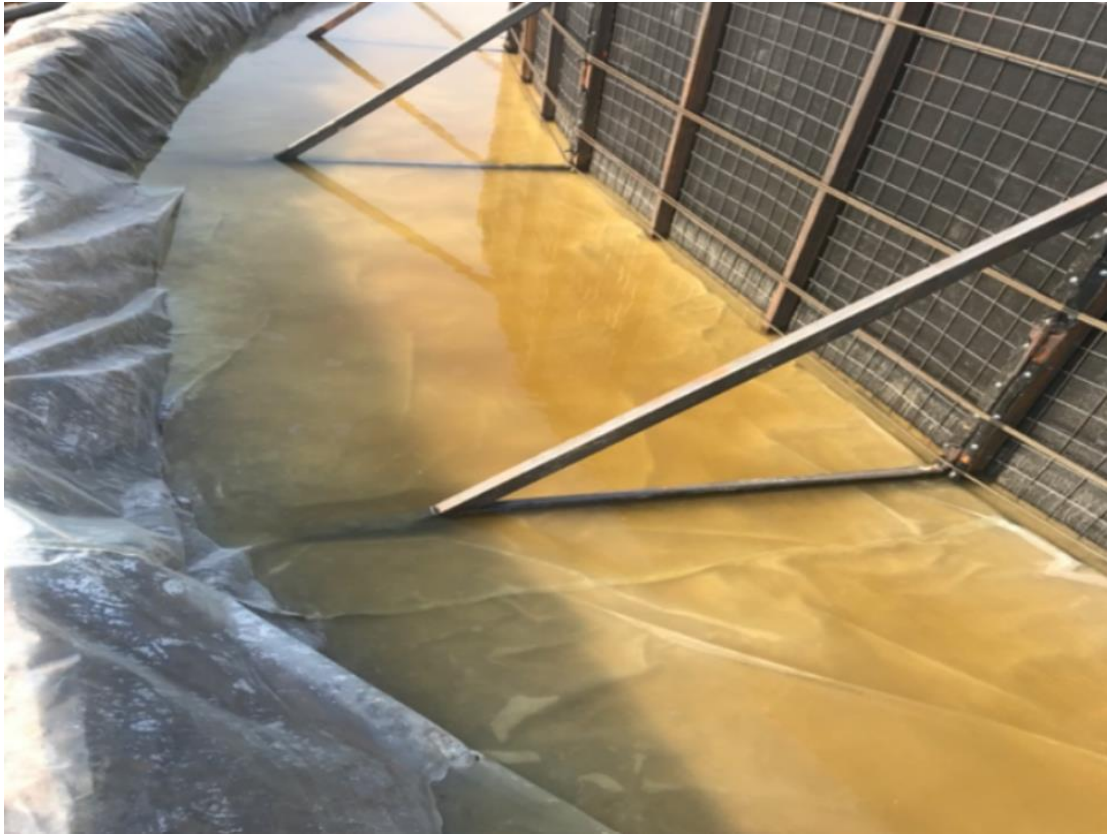
Рисунок 3.6 - Процес фільтрації води через стінку установки, після оброблення відходів буріння флокулянтами
