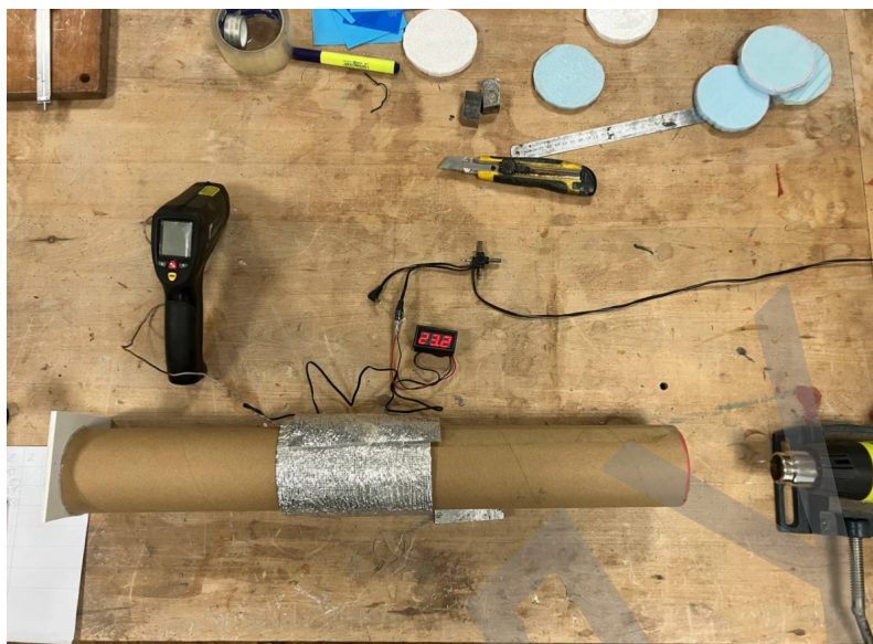
Рисунок 3.6 - Установка для випробувань на теплопровідність зразків сендвіч панелей.
