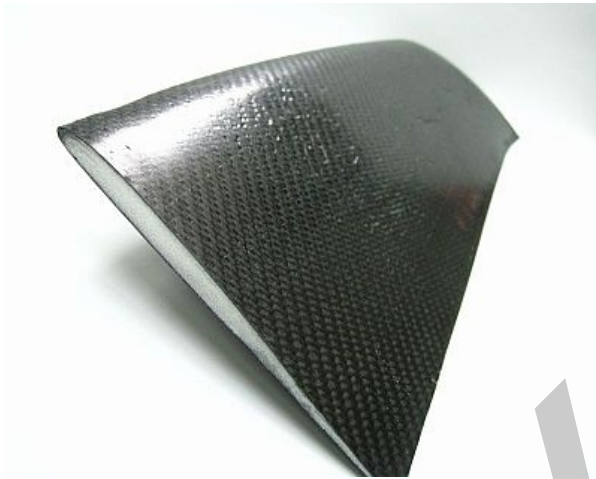
Рисунок 1.3 – Використання піни Rohacell для виготовлення сендвіч панелей (матеріали фірми «TASUNS» КНДР).
