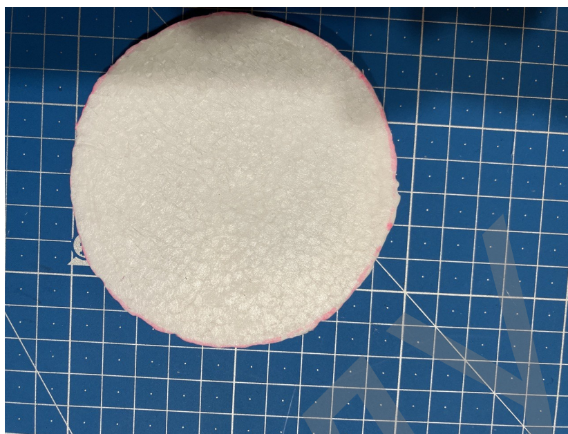
Рисунок 3.7 - Поверхня не ламінованого зразка з якісного пінополістиролу.
